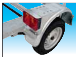
Astintaso lokasuojissa, suojatut takavalot.
