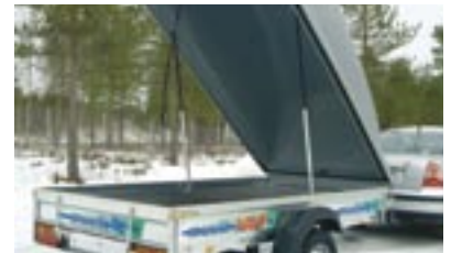
Pitkät ja voimakkaat kaasujouset keventävät avaamista ja tukevat nostettua kuomua. Riittävä avautuminen helpottaa lastausta myös kippiasennossa.
