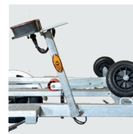
Venettä laskettaessa ja nostettaessa takavalot voidaan nostaa sivulle/ylös.
