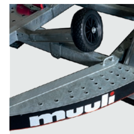
Uusi sivutukipyörä on kevyt ja joustava eikä värjää veneen pohjaa.
