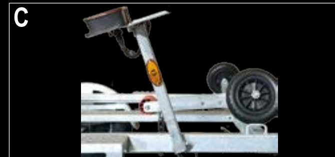
Venettä laskettaessa ja nostettaessa takavalot voidaan nostaa sivulle/ylös. När båten sjösätts och tas upp kan baklyktorna vridas åt sidan uppåt.
