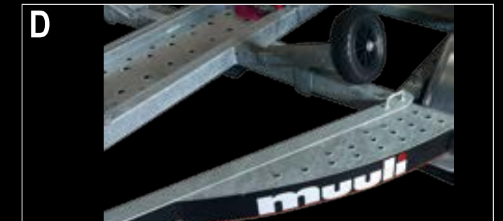
Uusi sivutukipyörä on kevyt ja joustava eikä värjää veneen pohjaa. Modellerna är försedda med lätta och fjädrande sidostödhjul som färgar inte.
