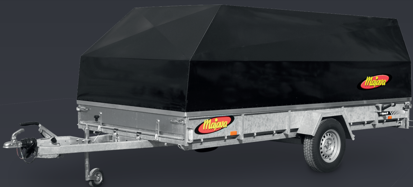
Aluminiumkåpa till alla modeller i valfria höjder och tre valfria färger. (svart, vit och mörkgrå)
